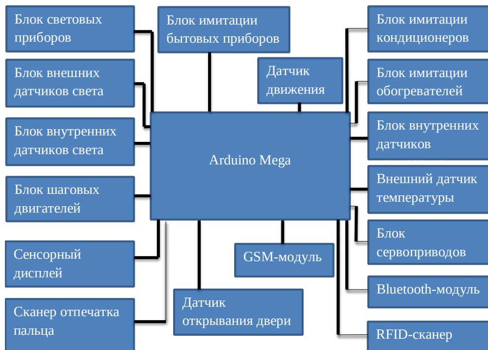
Рис.1 – Функциональная схема системы управления «Умным домом»
